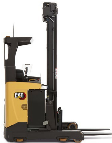
NR14N3C представлений зі звуженою кабіною і опцією напрямляючих рейок
