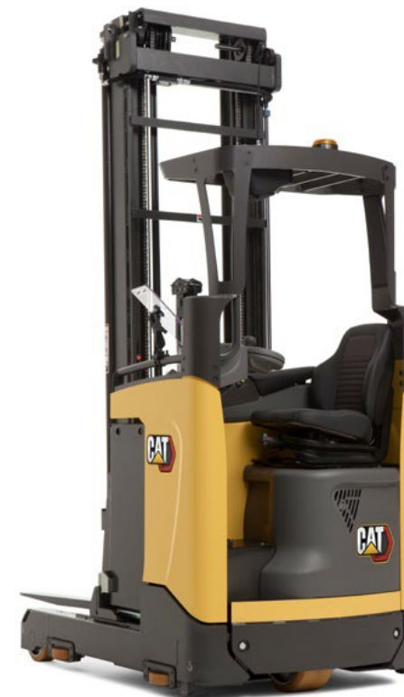
NR14N3C представлений зі звуженою кабіною і опцією напрямляючих рейок
