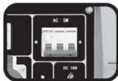
Крок 3. Вимкніть автоматичний вимикач
