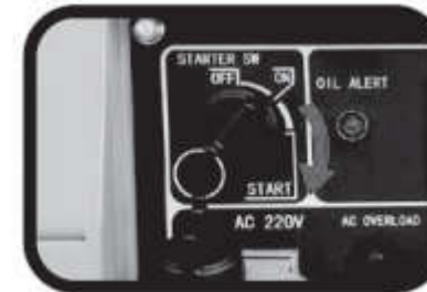
Крок 9. Переведіть перемикач запуску в положення "START" та запустіть двигун
