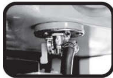
Крок 6. Відкрийте паливний клапан
