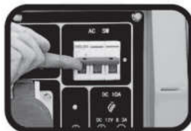
Крок 11. Ввімкніть автоматичний вимикач
