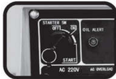
Крок 8. Переведіть перемикач запуску в положення "ON"
